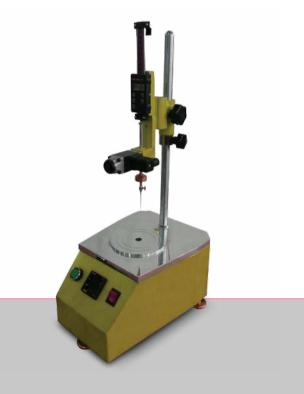
Semi-Automatic Bitumen Penetrometer (A-090/SA)
